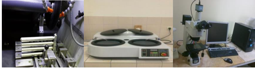
Şekil 1. a)Hassas Kesme ve b) Zımparalama ve Parlatma Cihazı ve c)Optik Mikroskop
