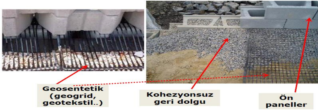
Şekil 2.9. Geosentetiklerle zemin güçlendirmesi
