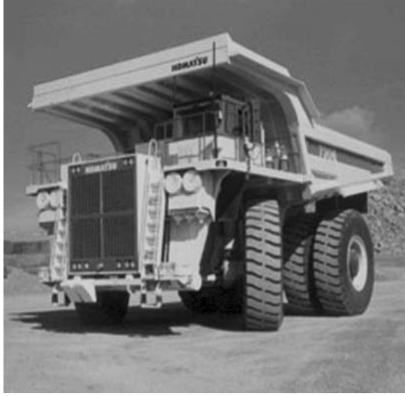
Şekil 1. 170 ston taşıma kapasiteli kamyon.
