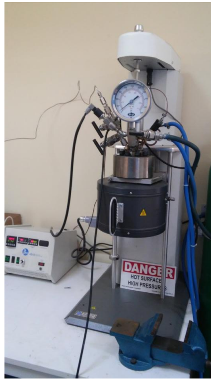
Şekil 5.1. Hidrotermal ön işlem için kullanılan reaktör düzeneği.
