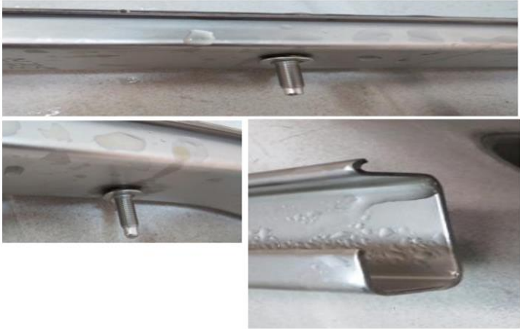
Şekil 7.6. Elektropolisajlı ürün 720 saat tuz sisi korozyon testi
