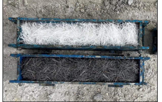
Şekil 6. Eğilme dayanımı deneyi için üretilecek kiriş numune kalıplarına önceden lif yerleştirilmesi
