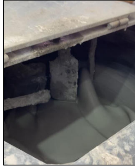
Şekil 2. SIFCON karışımının beton karıştırıcısında üretimi
