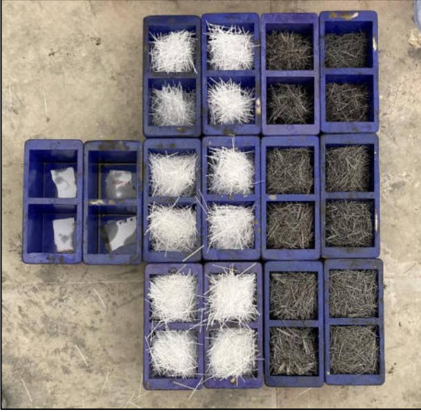
Şekil 4. Basınç dayanımı deneyi için üretilecek küp numune kalıplarına önceden lif yerleştirilmesi
