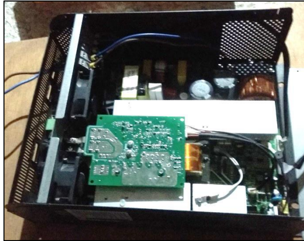
Şekil 3.12. Akıllı şebeke bağlantılı 1kW sinüs eviricinin iç yapısı
