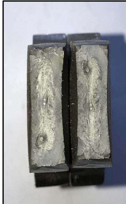
Şekil 5.23. 12-X-52 numunesinde kırılma yüzeyi (Alan: 300 mm 2 ).
