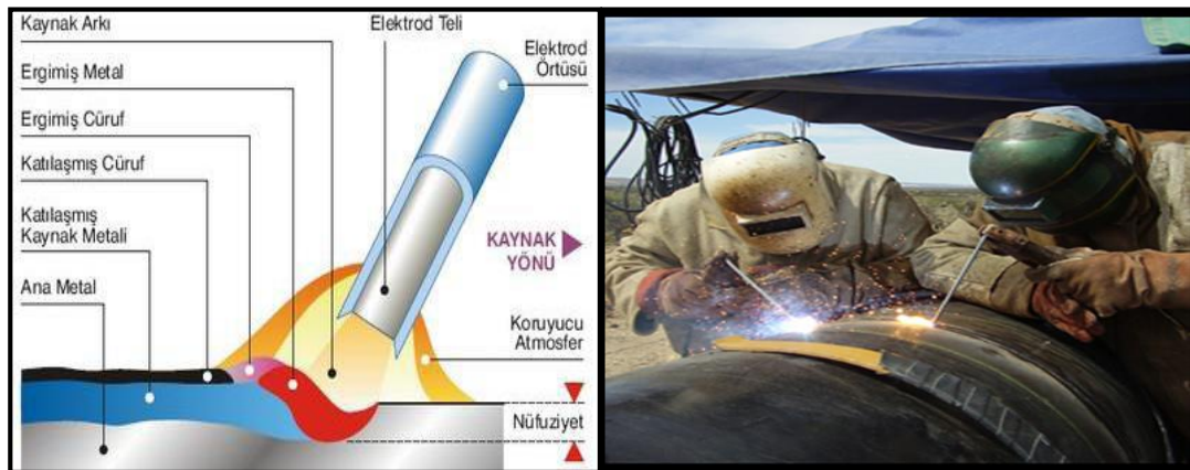
Şekil 3.3. Örtülü elektrik ark kaynağı.
