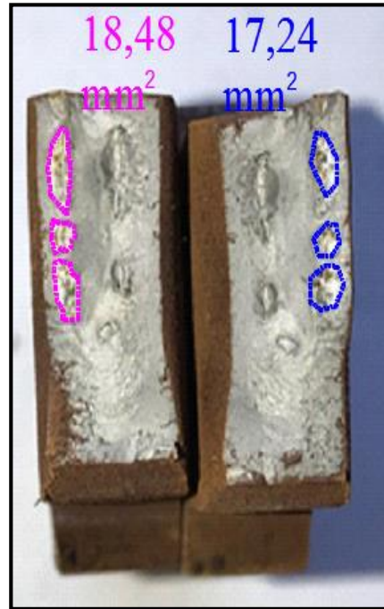
Şekil 5.19. 12-Y-44 numunesinde kırılma yüzeyi (Alan: 300 mm 2 ).
