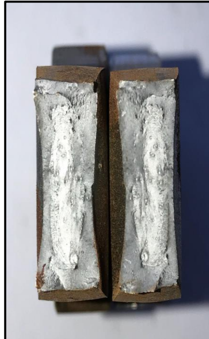
Şekil 5.21. 12-Y-60 numunesinde kırılma yüzeyi (Alan: 300 mm 2 ).
