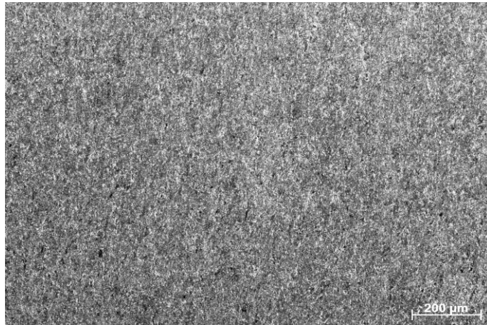
Şekil 5.57. 12-Y-44 tipi numunede kaynak bölgesi iç yapısı (100x).
