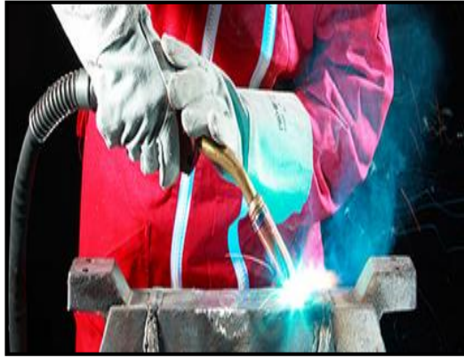
Şekil 3.6. Gaz altı ark kaynağı yapılışı.
