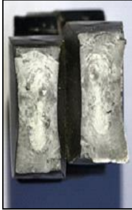
Şekil 5.16. 12-V-44 numunesinde kırılma yüzeyi (Alan: 300 mm 2 ).
