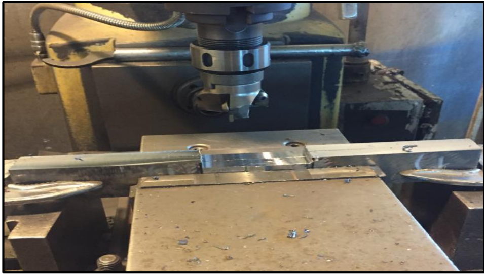
Şekil 4.20. Çekme numunelerinin CNC tezgahında işlenmesi.
