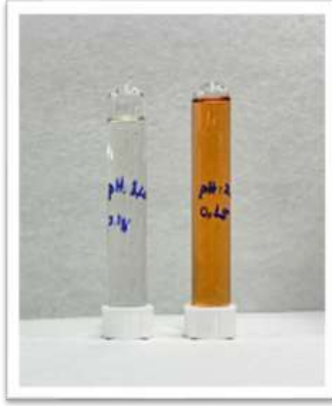
Şekil 5. 1. Boyarmadde çözeltisinde pH'n etkisi ( \text{ZnCl}_2 -AC pH 1,00 ve 2,00 giderim sonrası süzöntü)
