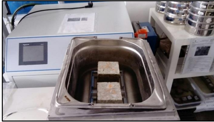
Şekil 4.11. CDF %3 tuzlu su çözeltisi doyurma işlemi.
