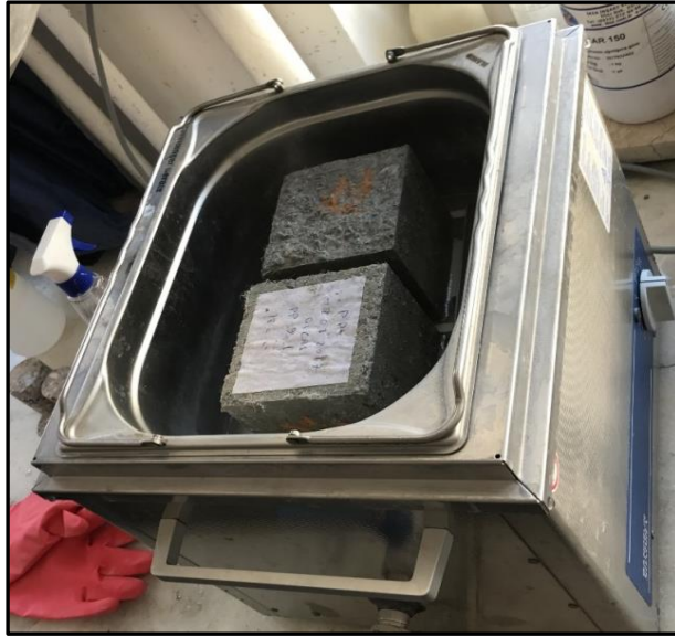
Şekil 4.13. CDF deneyinde numunelere ultrasonik banyo uygulanması.
