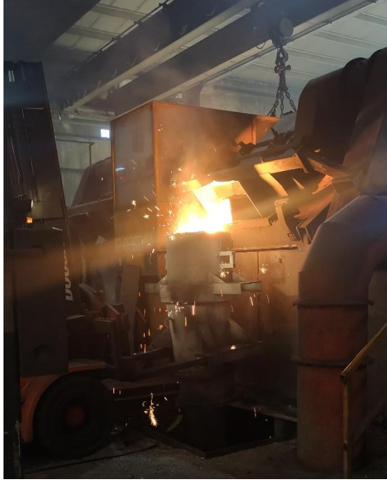
Şekil 4.22. Ocaktan tretman potasına sıvı metalin aktarılması
