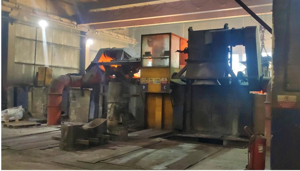
Şekil 4.12. 5 tonluk EGES marka indüksiyon ocakları
