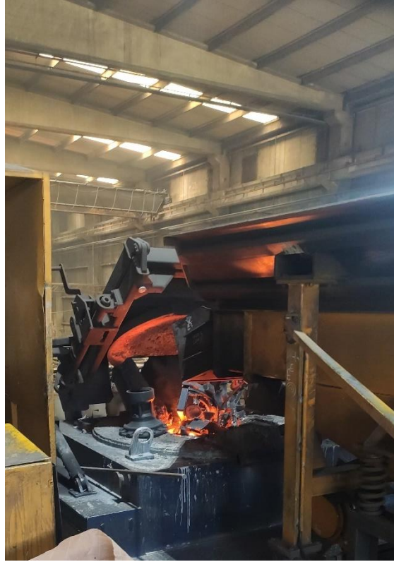
Şekil 4.14. SiC ilaveli ocağın yüklenme görüntüsü
