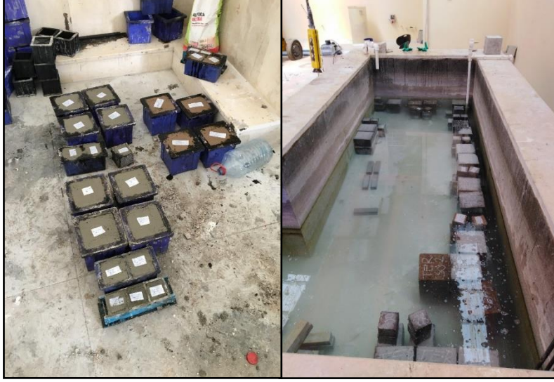
Şekil 4.12. Numune kalıpları ve kür havuzu
