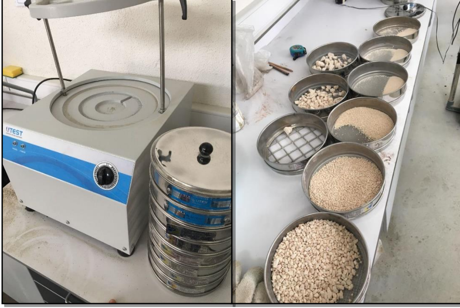
Şekil 4.9. Elek analizi deneyi yapılışı ve kullanılan elek serileri
