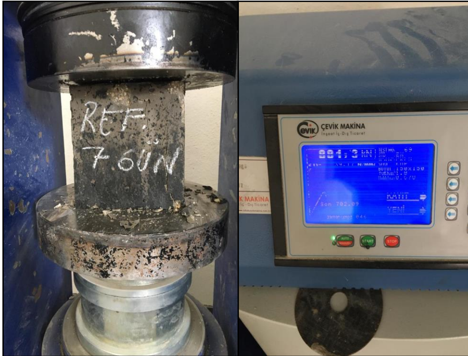
Şekil 4.16. Beton basınç deneyi yapılışı
