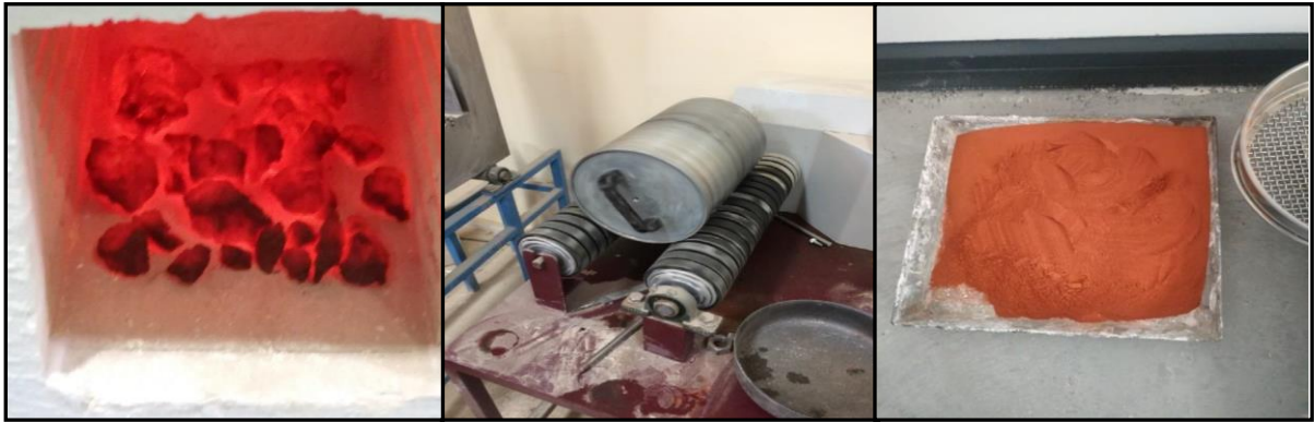
Şekil 4.8. Terra rosa malzemesinin kalsinasyon ve öğütme süreçleri
