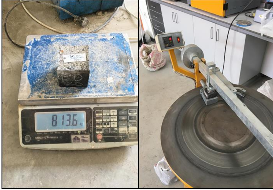
Şekil 4.20. Aşınma deneyi yapılışı
