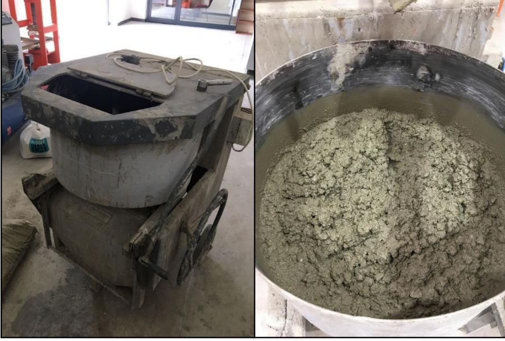
Şekil 4.11. Düşey eksenli laboratuvar tipi beton karıştırıcısı
