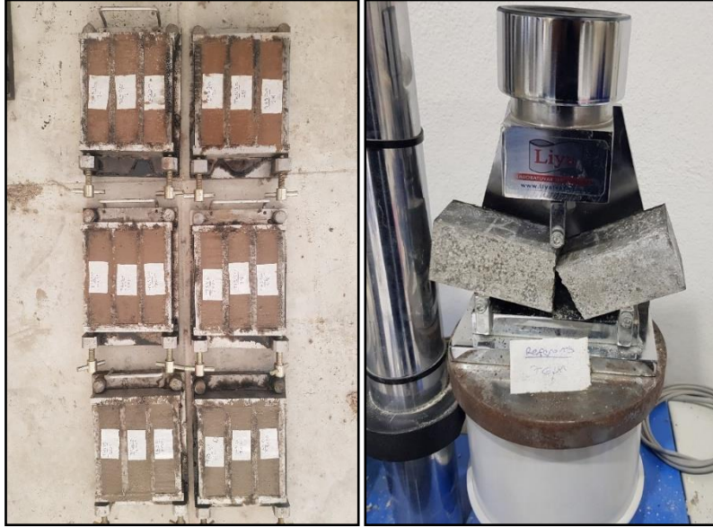
Şekil 4.17. Harç çubukları basınç deneyi
