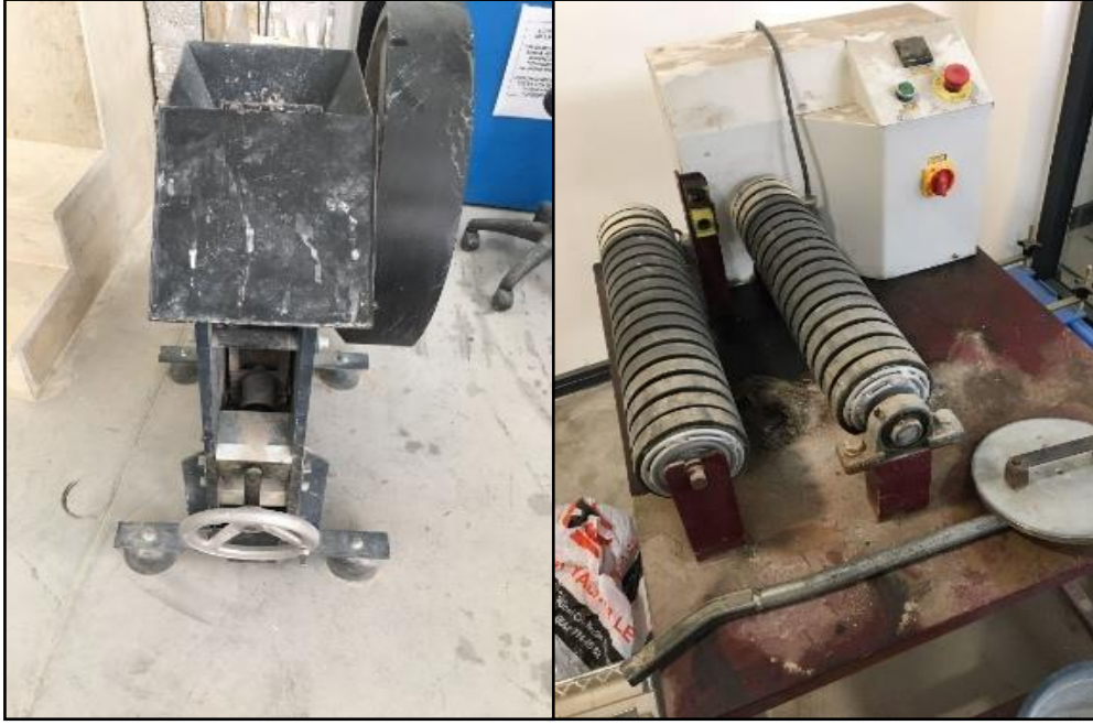
Şekil 4.6. Malzeme öğütme işleminde kullanılan çeneli kırıcı ve bilyalı değirmen
