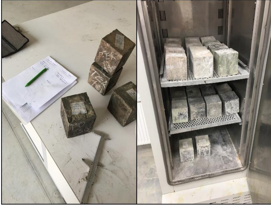
Şekil 4.19. Donma ve çözülme deneyi yapılışı
