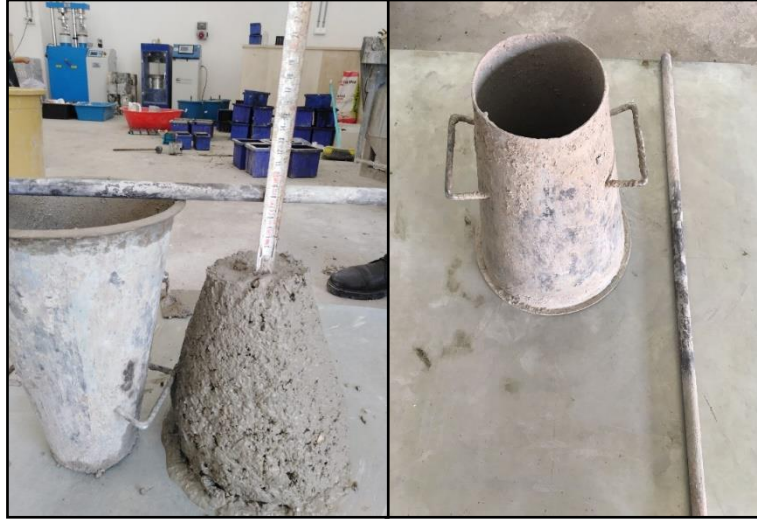
Şekil 4.14. Çökme deneyi yapılışı
