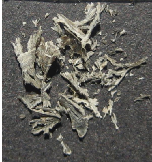
Şekil 4.6 Delaminasyon aşınma tabakaları (50X) (Abdelbary, 2015).
