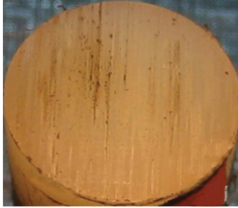
Şekil 4.4. Poliamid 66 yüzeyine gömülü abrazif partiküller (Abdelbary, 2015).
