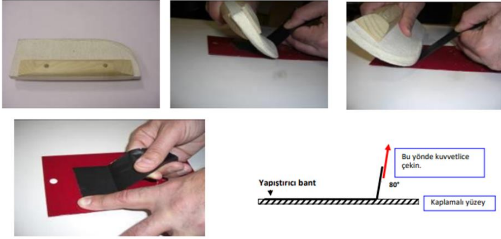
Şekil 8.3. Özel yapışma bandının kullanılması.
