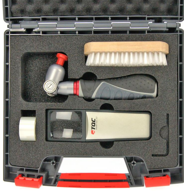
Şekil 8.1. Cross Cut test ekipmanları.
