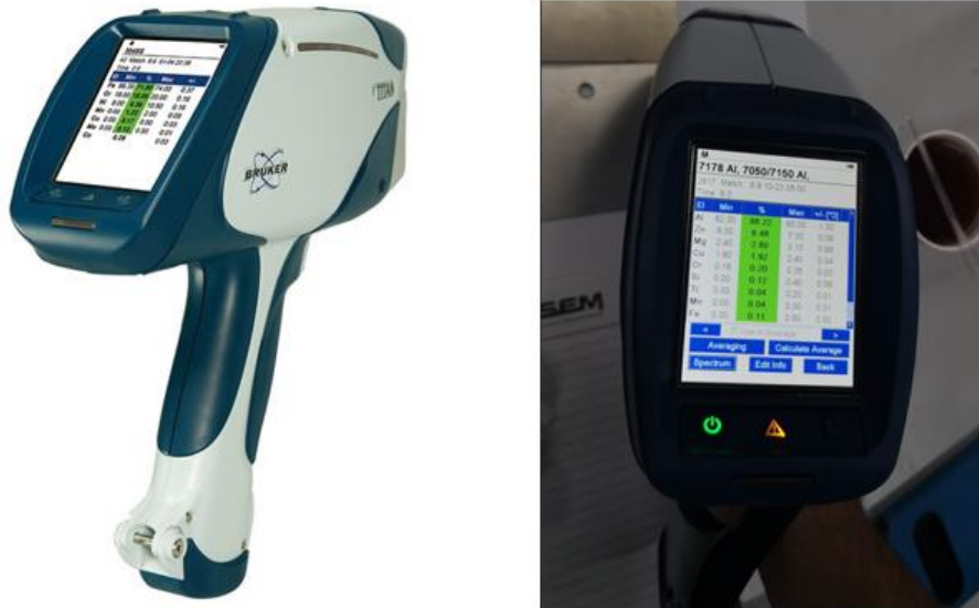
Şekil 8.7. El tipi Bruker XRF S1 TITAN 600 cihazı.
