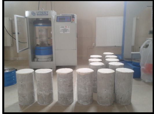
Şekil 3.10. Silindir numunelere uygulanan alçı başlıklar.
