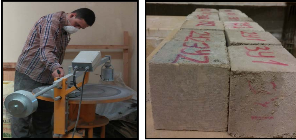
Şekil 3.15. Böhme aşınma deneyinin yapılışı.
