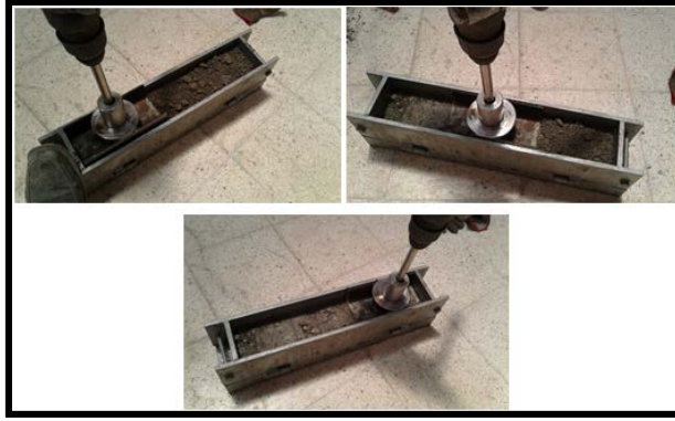
Şekil 3.5. Prizmatik kalıplara SSB numune yerleştirilmesi.
