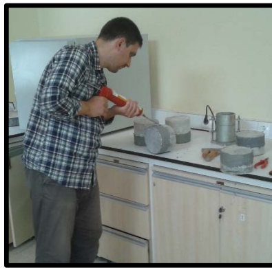
Şekil 3.17. CDF deney numunelerine epoksi uygulanması.
