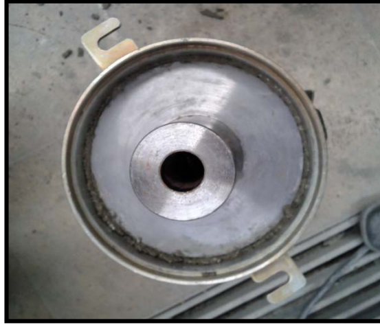
Şekil 3.2. Titreşimle sıkıştırılmış numune, kalıp ile plaka arasındaki harç oluşumu.
