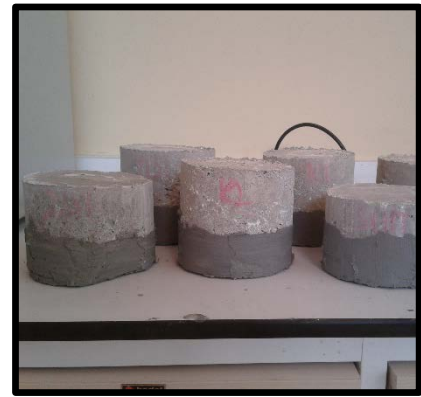
Şekil 3.17. CDF deney numunelerine epoksi uygulanması.
