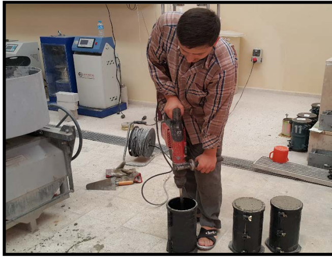
Şekil 3.3. Titreşimli tokmakla numune hazırlanması.
