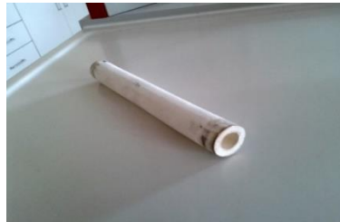
Şekil 3.1 Tübüler seramik ( \alpha\text{-Al}_2\text{O}_3 ) membran modülü. (Kızıler, B., 2017).
