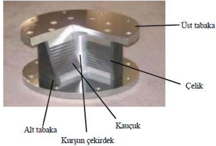
Şekil 1.7. Kurşun çekirdekli kauçuk izolatör (Kalpakidis ve Constantinou, 2009).
