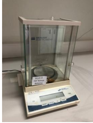
Şekil 4.3. Tez Çalışmasında Kullanılan Hassas Terazi
