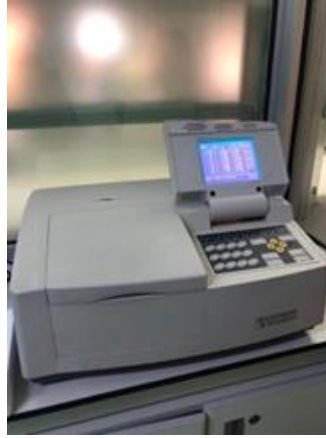
Şekil 4.4. Tez Çalışmasında Kullanılan UV-Vis Spektrofotometre
