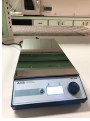
Şekil 4.5. Tez Çalışmasında Kullanılan Manyetik Karıştırıcı.
