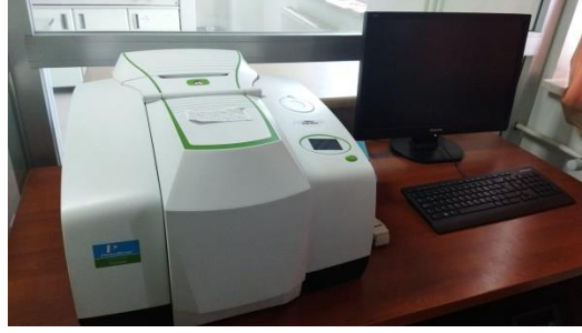
Şekil 4.8. Tez Çalışmasında Kullanılan FTIR Spektrofotometre Cihazı
