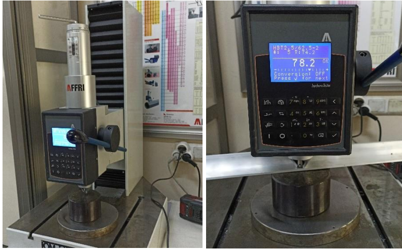
Şekil. 6.15. Sertlik Cihazı ve Yaşlandırma Sonrası Ölçülen Profil
