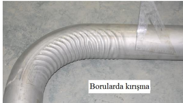
Şekil 2.12. Borularda görülen kırışma kusuru
