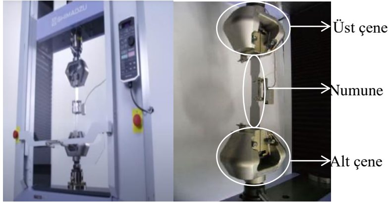
Şekil 4.1. Malzemelerin mekanik özelliklerini belirlemek için kullanılan çekme cihazı
