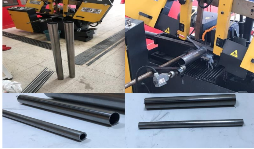
Şekil 4.2. Dairesel kesitli boruların parçalara ayrılması
