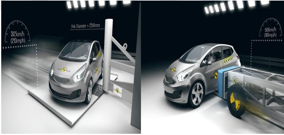
Şekil 1.2. Araçların yan tarafına uygulanan güvenlik testleri
