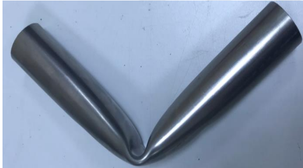
Şekil 4.15. DP 800 kalite malzemenin S-100 mesnet aralığının deneysel ve sonlu elemanlar ortafındaki görüntülerinin karşılaştırılması.
