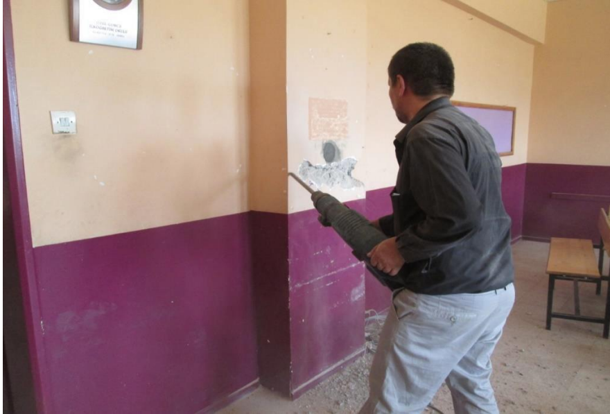
Şekil 4.4. Tahribatlı Yöntemle Donatı Tespiti
