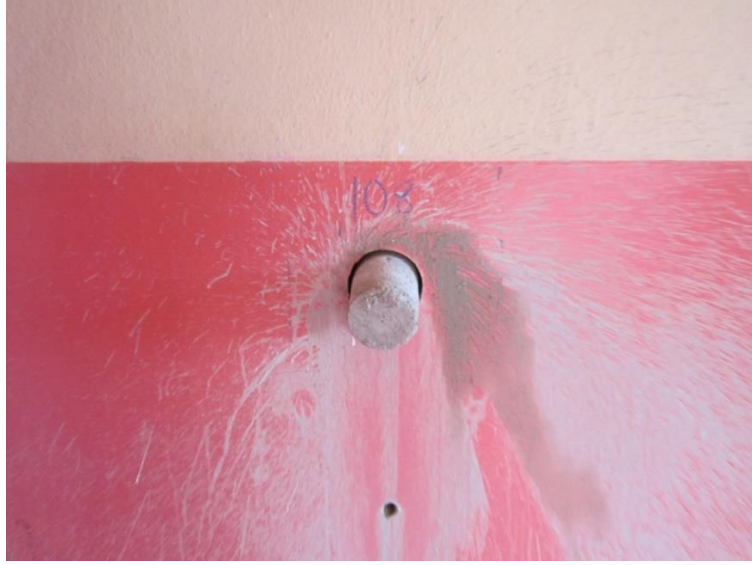
Şekil 4.3. Karot Numunesi Alımı
