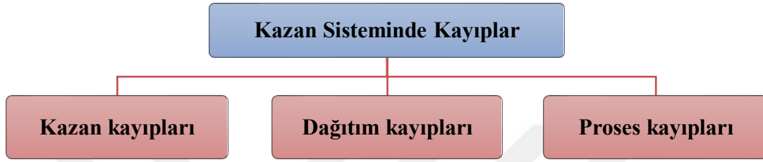
Şekil 5.1. Kazan sisteminde kayıplar
