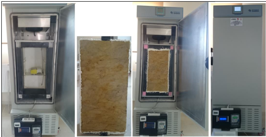
Şekil 4.13. Deney düzeneği aşamalarının taş yünü örneği.
