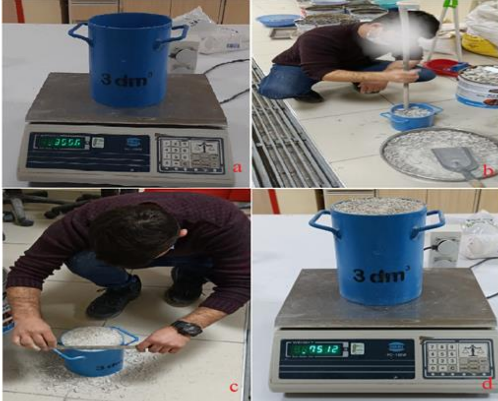
Şekil 4.4. Agregada Birim Hacim Ağırlık Deney Aşamaları. a) Hacim Kovasının Tartılması, b) Numunenin Şişlenmesi, c) Numunenin Tevsiyelenmesi, d) Numunenin Tartılması
