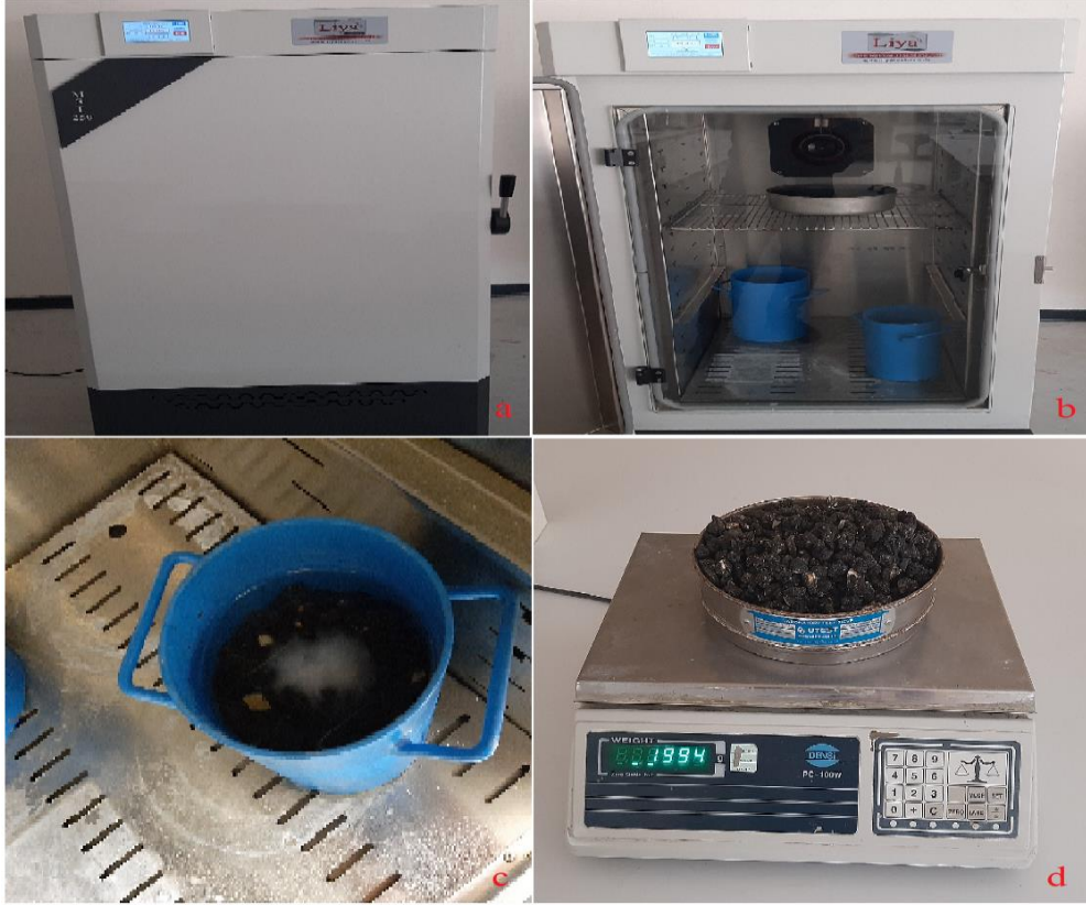
Şekil 4.5. Asfalt Kırığı Donma Çözünme Deney Aşamaları. a) Donma Çözünme Kabini, b) Numunelerin Kabine Konulması, c) Numunelerin -17,5 °C Düşürülmesi, d) Numunenin Tartılması
