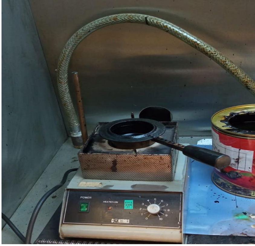
Şekil 4.9. Parlama Noktası Tayini Denei Aleti
