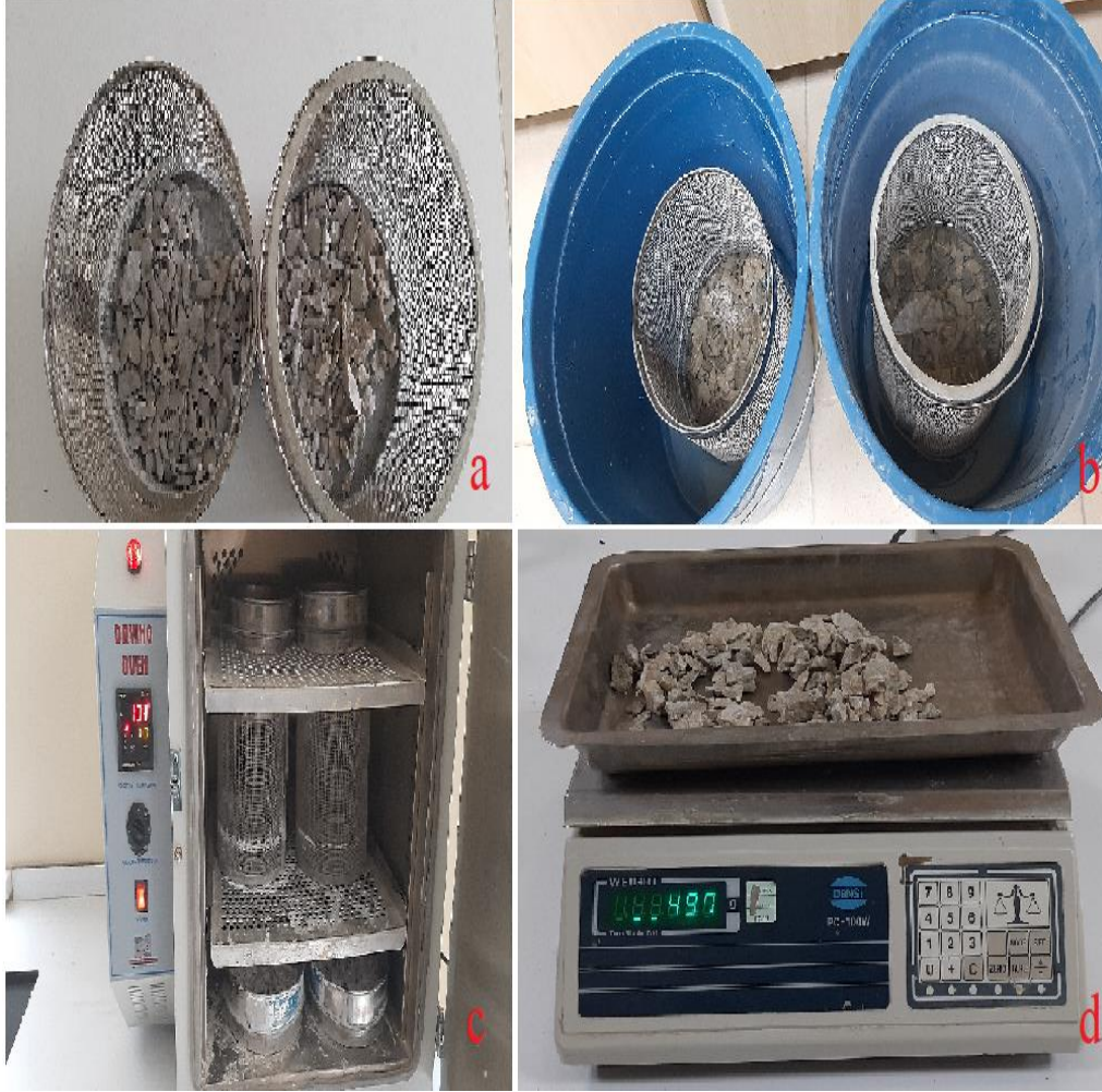
Şekil 4.6. Kimyasal Yolla Deney Aşamaları. a) Numunelerin Tel Sepete Konulması, b) Numunelerin Tuzlu Suya Bırakılması, c) Numunelerin Etüvde Kurutulması, d) Numunenin Tartılması
