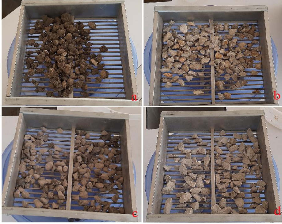
Şekil 4.2. Yassılık İndeksi Agregası Numuneleri. a) Asfalt Kırığı Agregası, b) Kireçtaşı Agregası, c) Bazalt Agregası, d) Mermer Atığı Agregası
