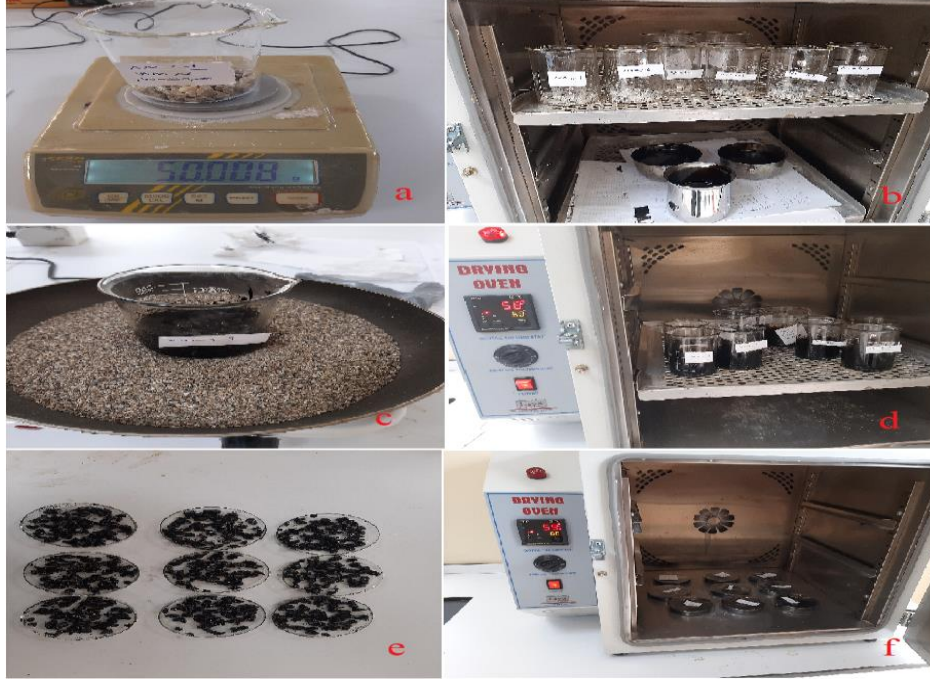
Şekil: 4.12. Nicholson Soyulma Deneyi Aşamaları. a) Agrega hazırlanması, b) Agrega 1 saat etüvde bekletilmesi, c) Beherin kum banyosunda karıştırılması, d) Hazırlanan numunelerin etüvde bekletilmesi, e) Beherdeki numunelerin Petri kabına konulması, f) Su dolu Petri kaplarının etüvde bekletilmesi
