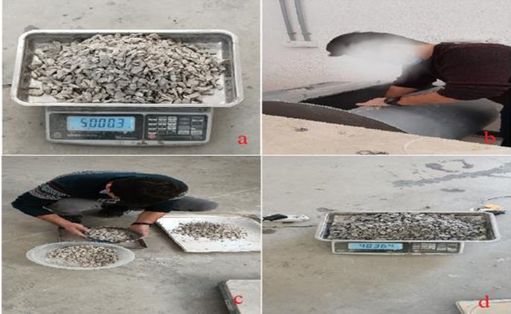
Şekil 4.1. Los Angeles Deney Aşamaları a) Numune Hazırlanması, b) Numunelerin Deney Aletine Yerleştirilmesi, c) Eleme İşlemi, d) Agregaların Eleme Sonucunda Tartılması
