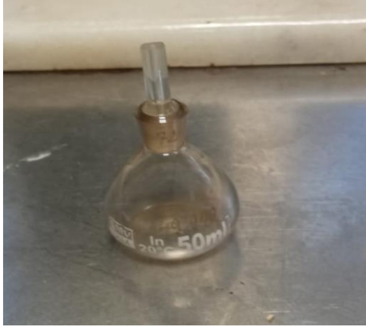
Şekil 4.10. Özgül Ağırlık Piknometresi
