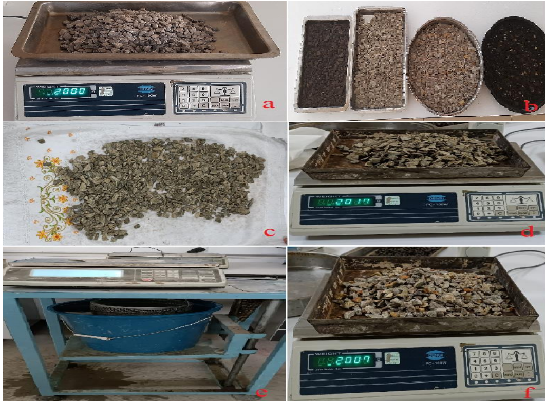
Şekil 4.3. İri Agrega Deney Aşamaları. a) Numunenin Hazırlanması, b) Numunelerin Suya Koyulması, c) Numunelerin Peçete Yardımıyla Kurutulması, d) Numunelerin Tartılması, e) Agregaların Tel Sepetle Su Kovağına Konulması, f) Numunelerin Etüvde Kurutulduktan Sonraki Tartımı
