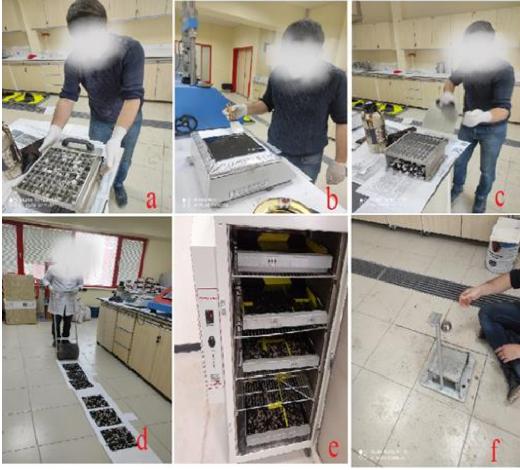
Şekil: 4.11. Vialit Deneyi Aşamaları. a) Agregaların Sericiye yerleştirilmesi, b) Plakaya Bitümün Yayılması, c) Agregaların Sericiden Plakaya Düşürülmesi, d) Silindirleme, e) 35 °C Su Banyosunda bekletilmesi, f) Çelik Bilya Düşürme
