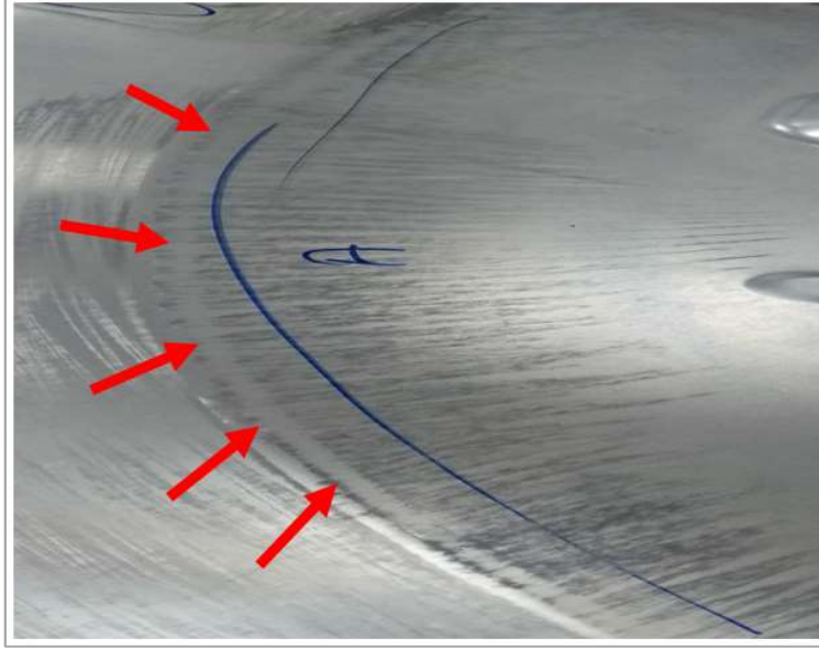
Şekil 4. Dış panel parçada iz yürümesi örneği
