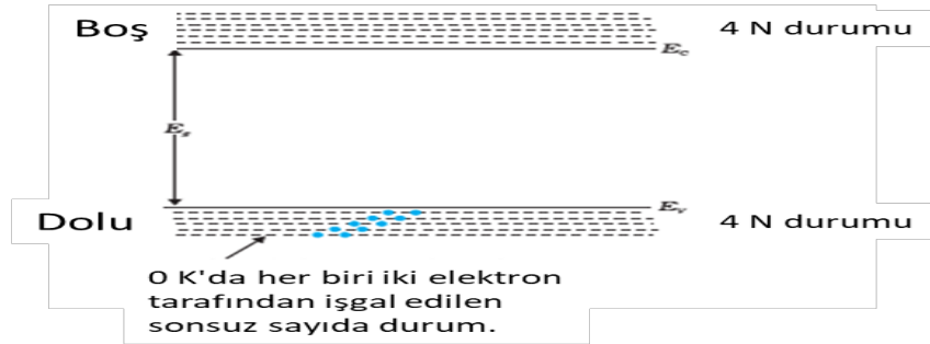
Şekil 2.2. Bir yarıiletkende 0 K'daki enerji bantı konumları (Kuldeep, 2022).
