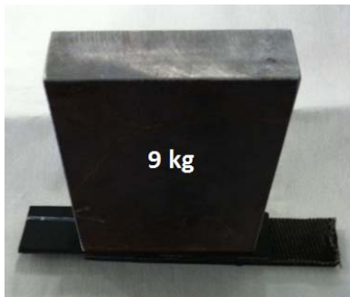
Şekil 3. Konveyör bant numunelerinin yapıştırılması
