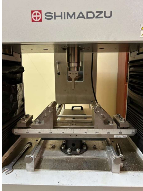
Şekil 4. Deneylerde kullanılan Shimadzu marka üniversal test cihazı
