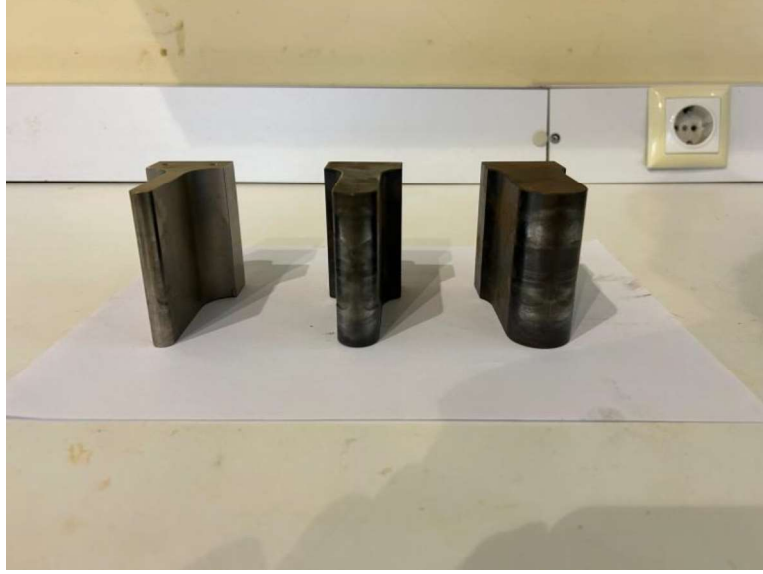
Şekil 6. Deneylerde kullanılan farklı radüslere sahip (R5, R10, R15) zımba geometrileri
