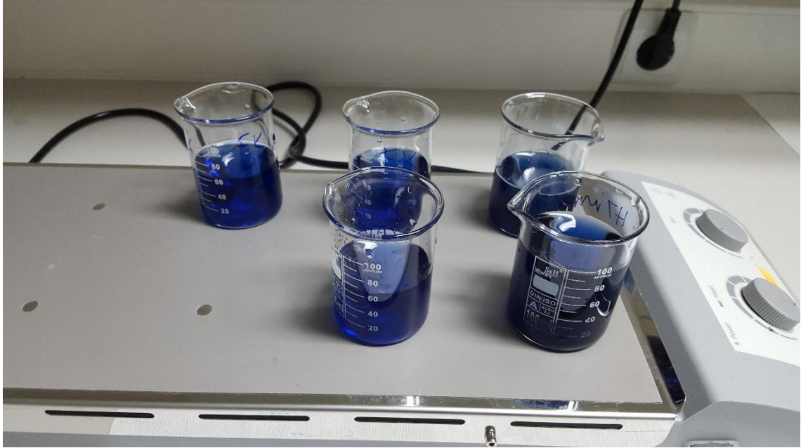
Şekil 2.2. Deneysel çalışmalarda kullanılan çok noktalı manyetik karıştırıcı.
