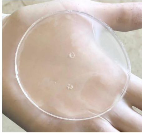
Şekil 4. 3. Tez çalışması kapsamında sentezlenen filmlere ait örnek görsel (Reçete 1: PVA)
