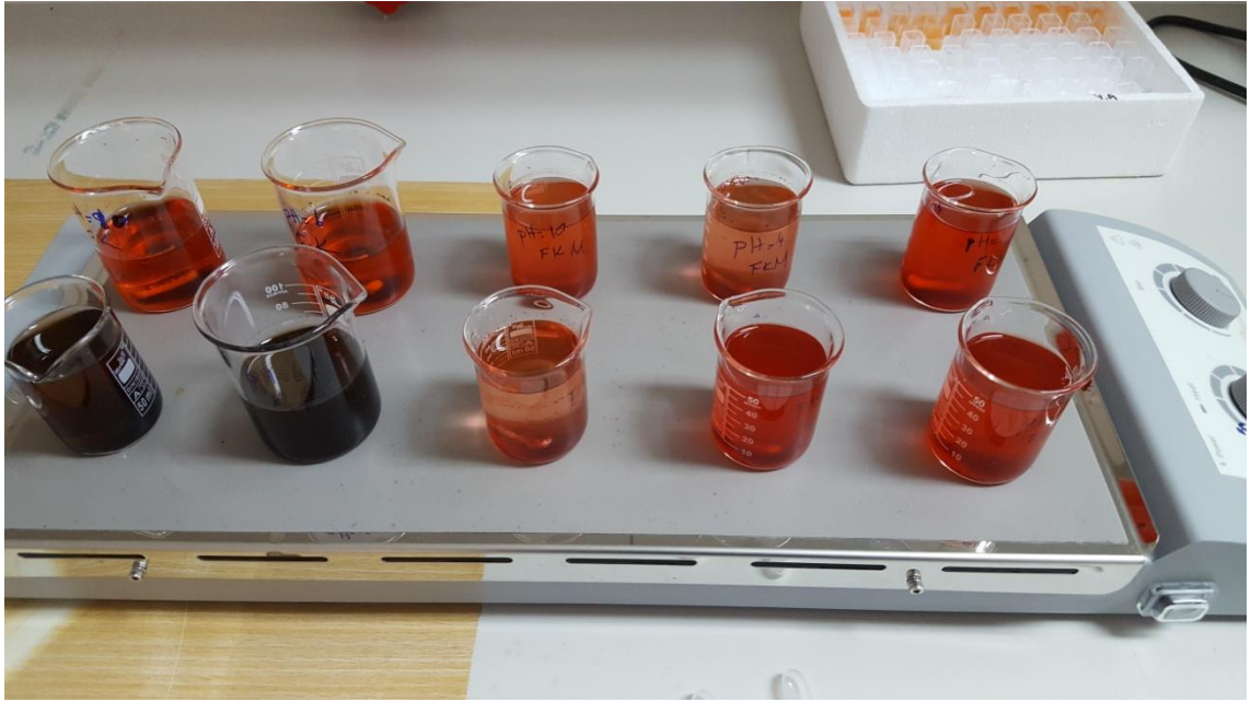
Şekil 3.2. Deneysel çalışmalarda kullanılan Mika marka çok noktali manyetik karıştırıcı.
