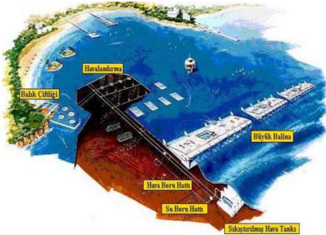
Şekil 4.21. Büyük balina enerji sisteminin şematik görünümü (Clément vd., 2002).
