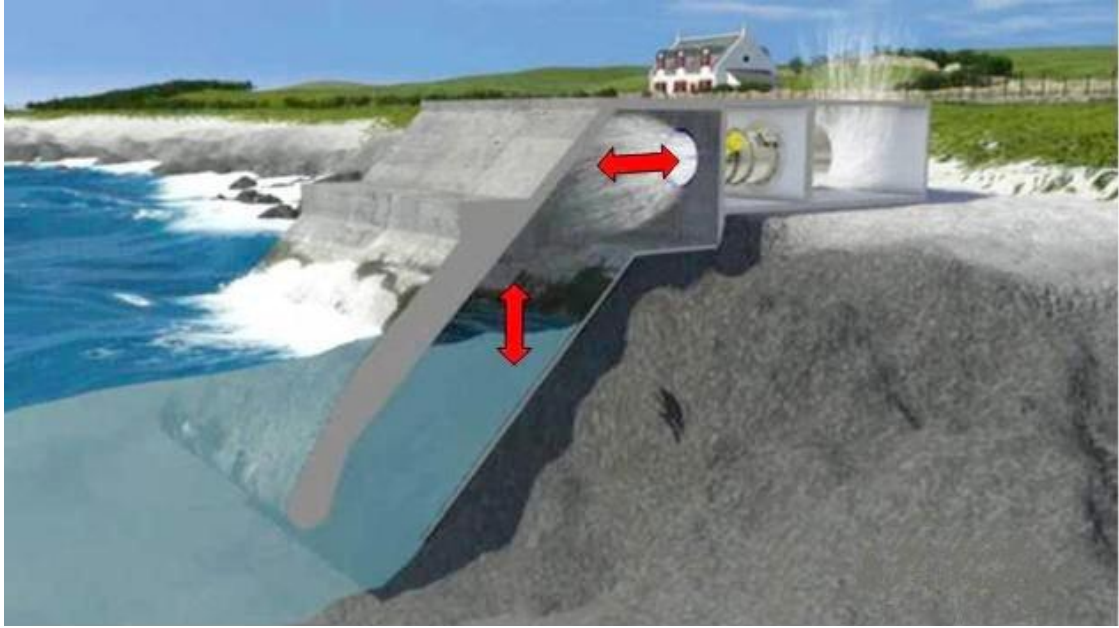
Şekil 4.2. OWC dalga enerjisi dönüşüm sistemi.
