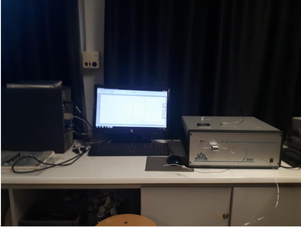
Şekil 3.21. Deneysel Çalışmalarda Kullanılan SRA Instrument \mu GC Cihazı
