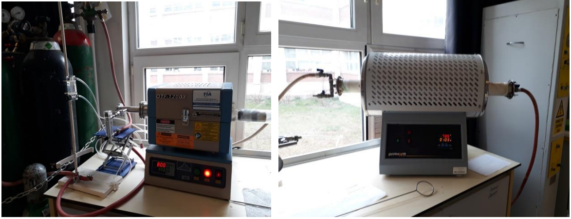
Şekil 3.1. Kalsinasyon Amacıyla Kullanılan Tüp Fırınlar
