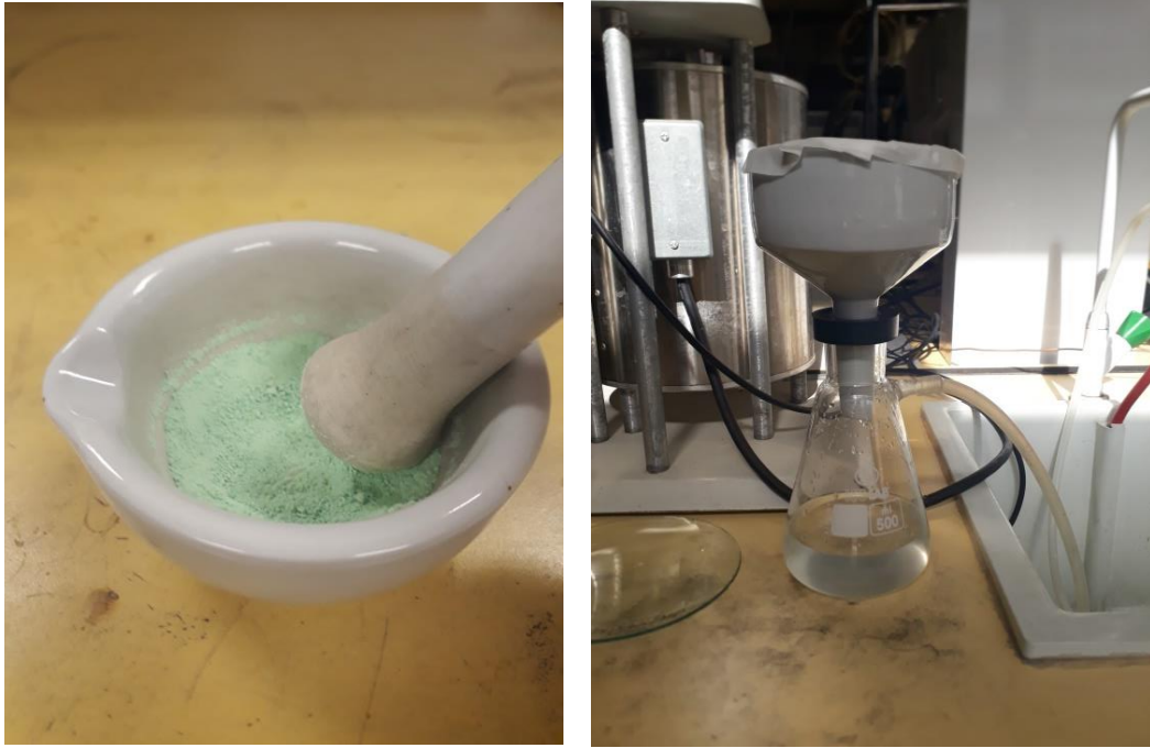
Şekil 3.4. Öğütme ve Süzme Düzenliğini Gösteren Katalizör Hazırlama Aşamaları
