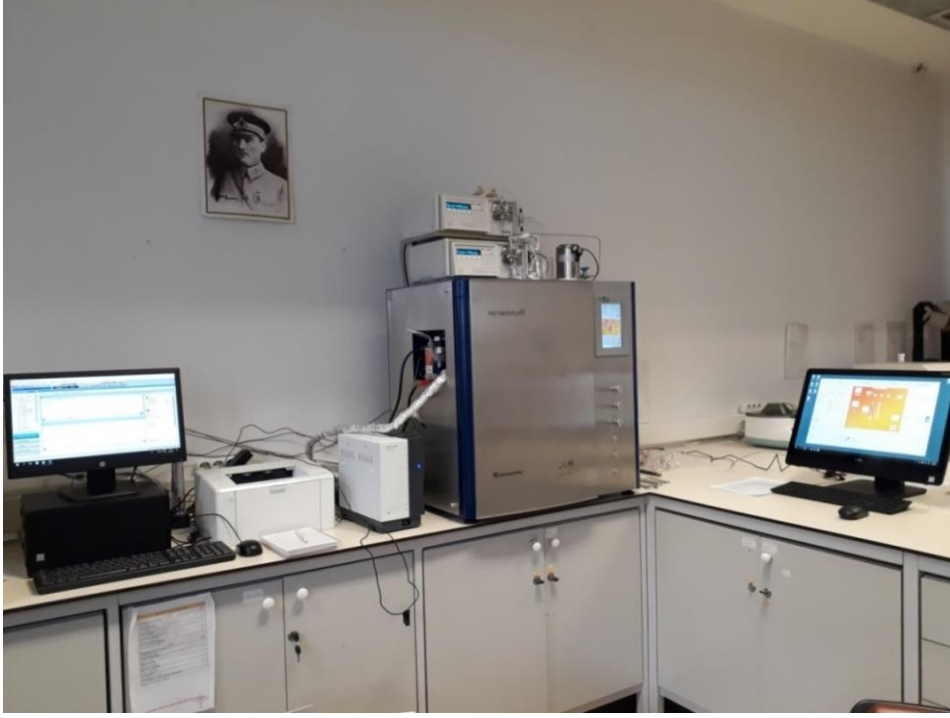
Şekil 3.18. Microactivity Effi Reaktör Sistemi ve Sisteme Doğrudan Bağlı \mu GC Cihazı
