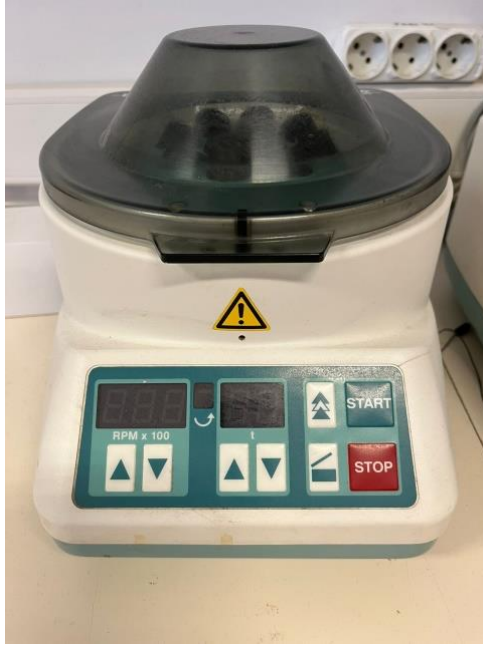
Şekil 3.3. Sütunlama Yönteminde Kullanılan Santrifüj Cihazı
