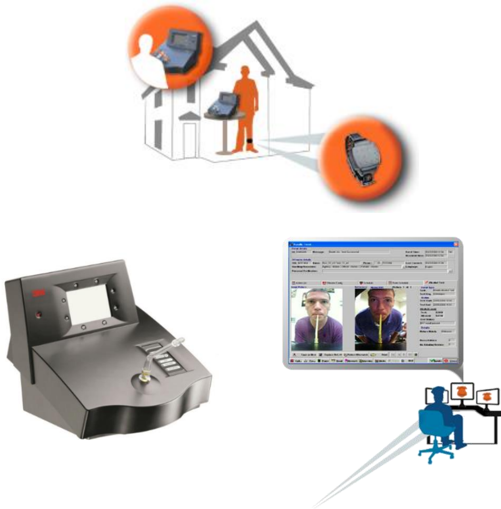
Şekil 4.8: Alkol izleme ünitesi çalışma şeması ve sistem bileşenleri.
