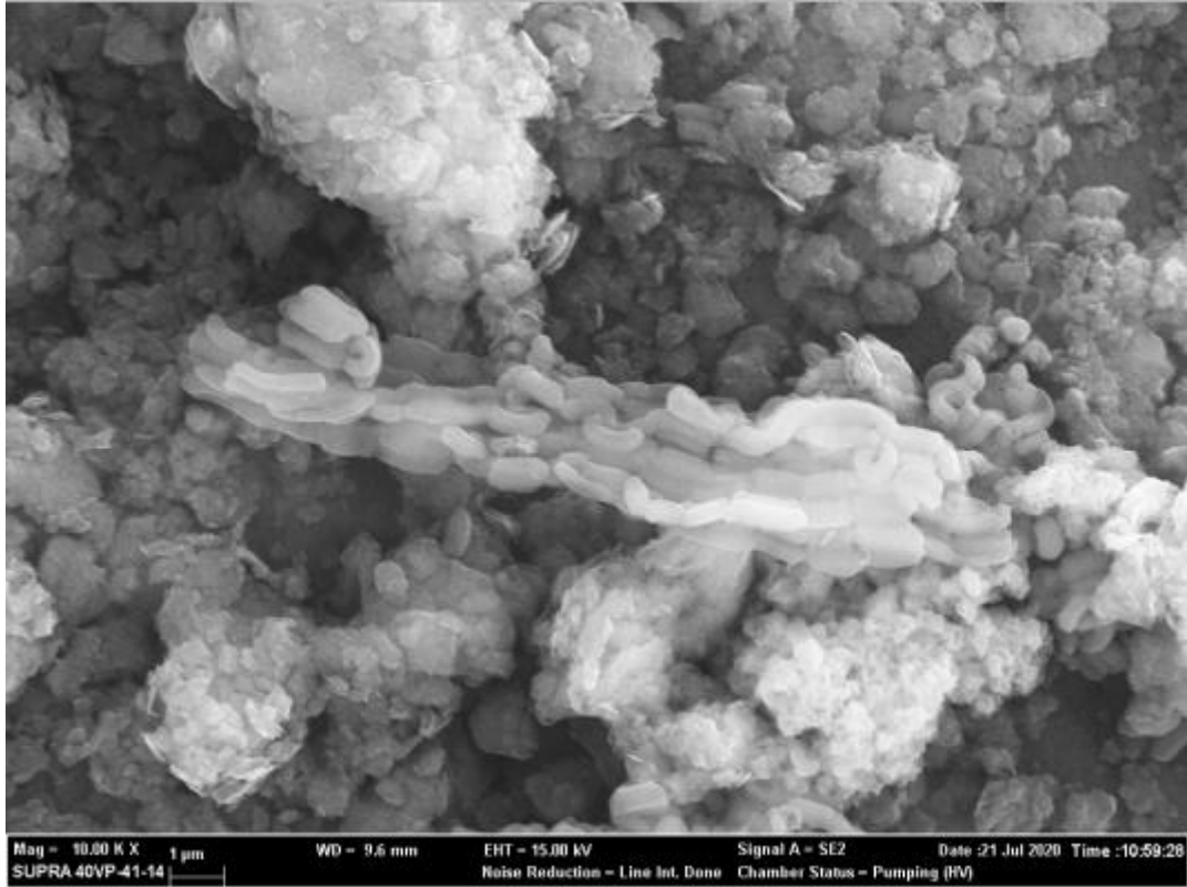
Resim 4.14. GO/SBA-15 baskı devre karbon elektrot malzemesine ait SEM görüntüsü (10 kx)
