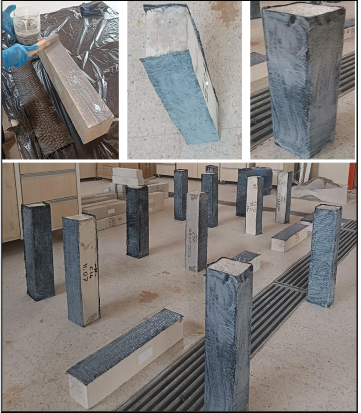
Şekil 4.4. Kirişlerin CFRP ile Sargılanması
