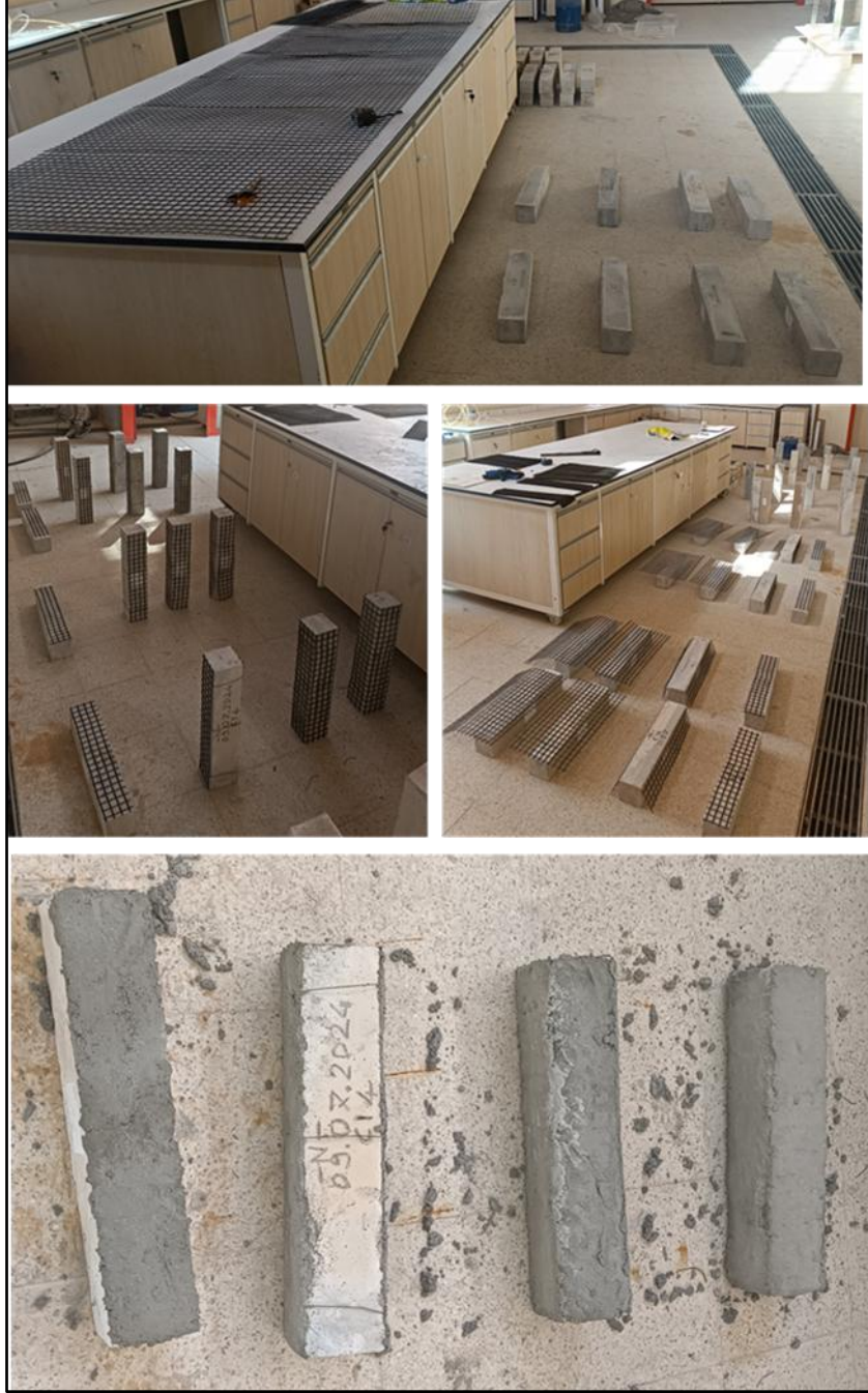
Şekil 4.5. Kirişlerin TRM ile Sargılanması
