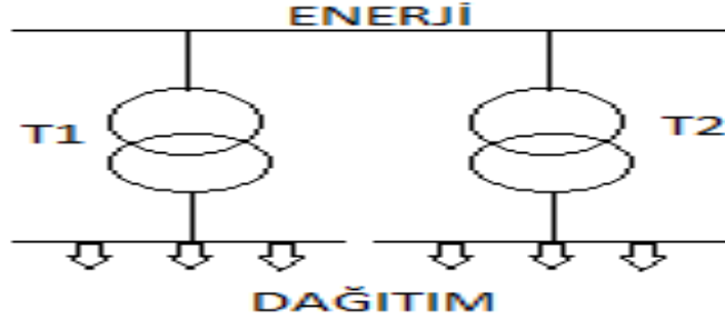
Şekil 4.2. Primerleri ortak paralel bağlama.
