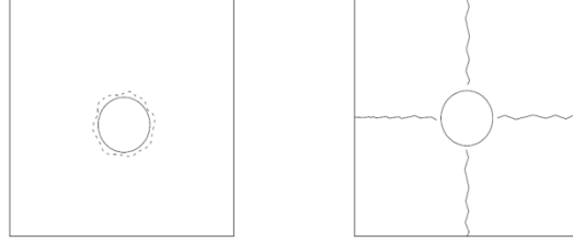
Şekil 2.1. Eksenel Çekip Çıkarma Deneyinde Düz Yüzeyle Çubuklarda Sıyrılma (a), Nervürlü Çubuklarda Ayrılma Bölgeleri (b) (Altan, 2013)
