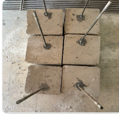
Şekil 4.10. Farklı Kenar Mesafelerinde Beton Bloklara Açılan Delikler
