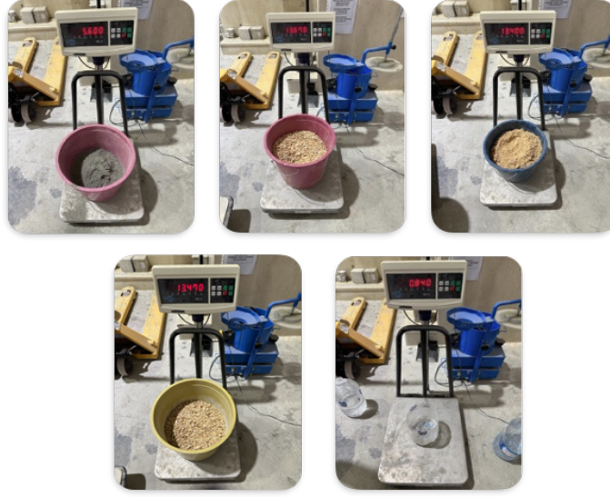
Şekil 4.2. Deney Numunesi Hazırlanırken Kullanılan Çimento, Agrega ve Su Görselleri
