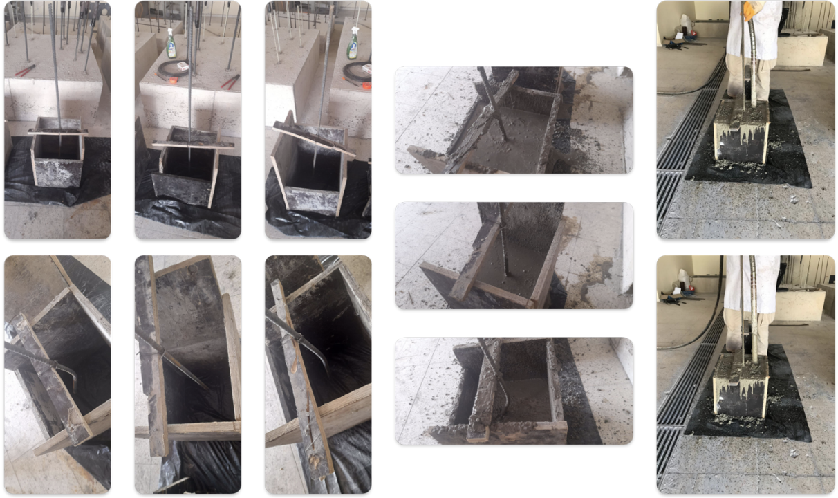
Şekil 4.3. Beton Numune Hazırlanması ve Donatı Yerleşimi
