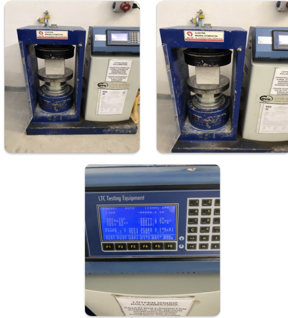
Şekil 4.1. Deney Numunesi Basınç Testi
