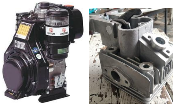
Şekil 3.1 Deney Motoru ve revize edilmiş silindir kapağı
