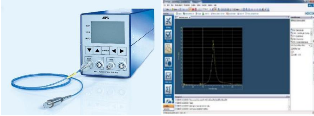
Şekil 3.8 Silindir içi basınç sensörü, sinyal düzenleyicisi ve ölçüm ara yüzü
