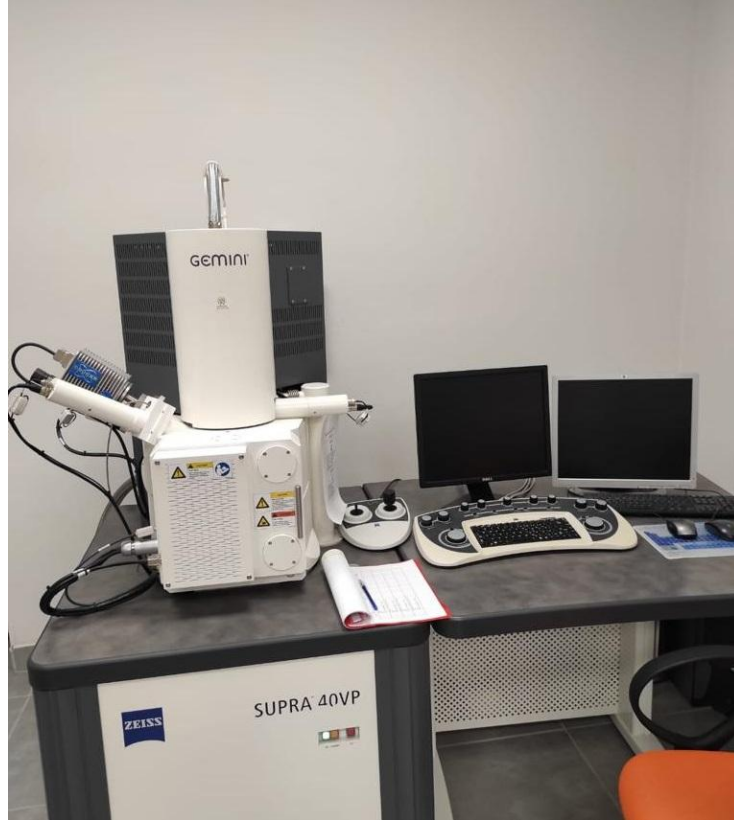
Şekil 5.13. Yüzeysel Karakterizasyonunda Kullanılan Alan Emisyon Taramalı Elektron Mikroskobu (FESEM)
