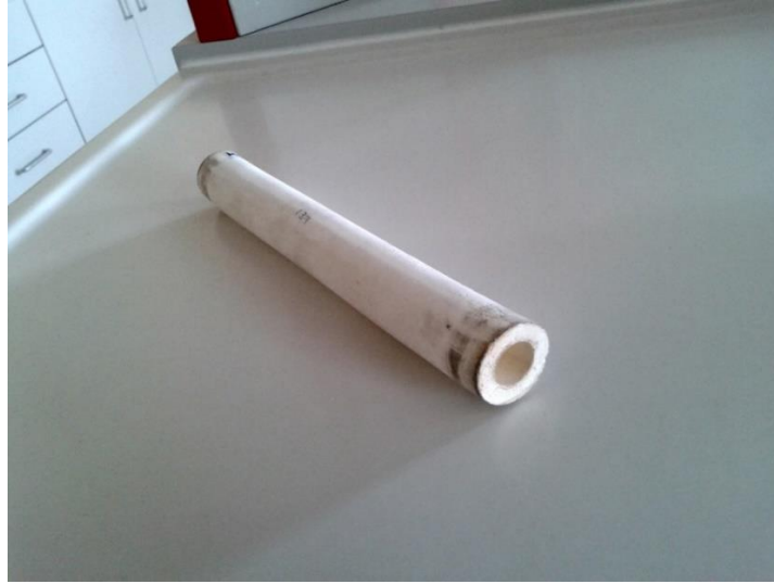
Şekil 4.1. Tübüler seramik ( \alpha -Al 2 O 3 ) membran.
