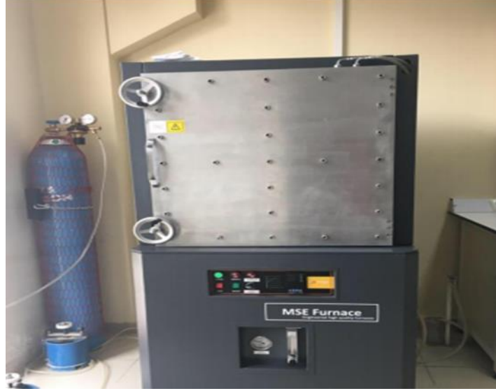
Şekil 5.5. Atmosfer kontrollü yüksek sıcaklık fırını
