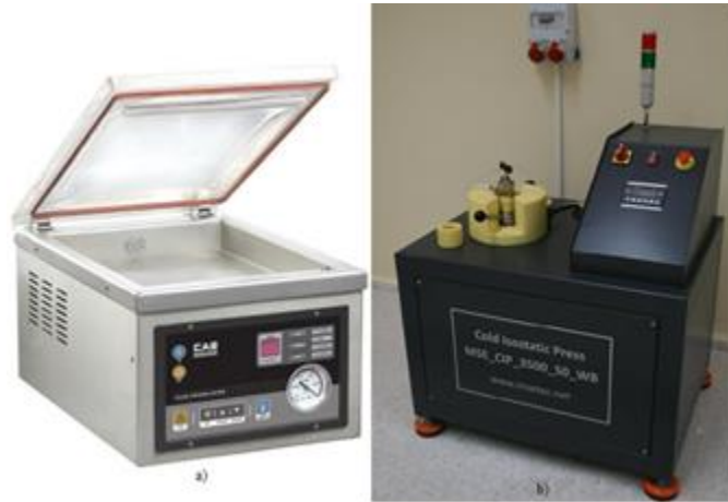
Şekil 5.4. Soğuk izostatik pres ve vakum makinesi (a: vakum makinesi, b: soğuk izostatik pres )
