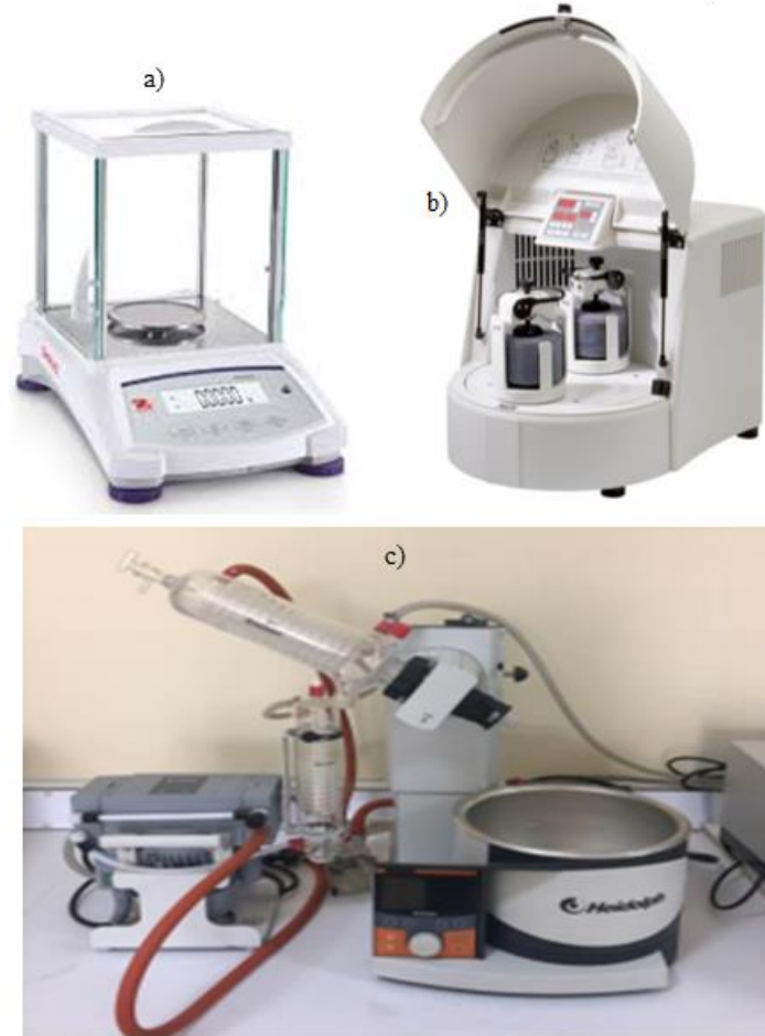
Şekil 5.2. Numunelerin hazırlanmasında kullanılan cihazlar (a: hassas terazi, b: gezegensel değirmen, c: vakumlu döner evaporatör)
