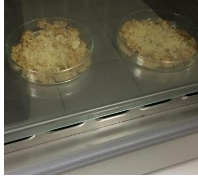
Şekil 5.2. Etüve Kurutulmak İçin Yerleştirilen Fabrika Katı Organik Atığı
