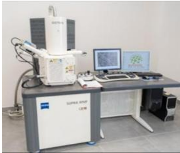
Şekil 5.10. ZEISS / Supra 40 VP SEM cihazı
