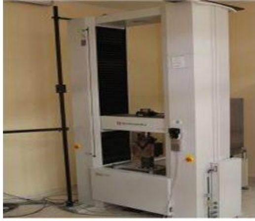
Şekil 5.9. SHİMADZU AG-IC çekme makaslama test cihazı
