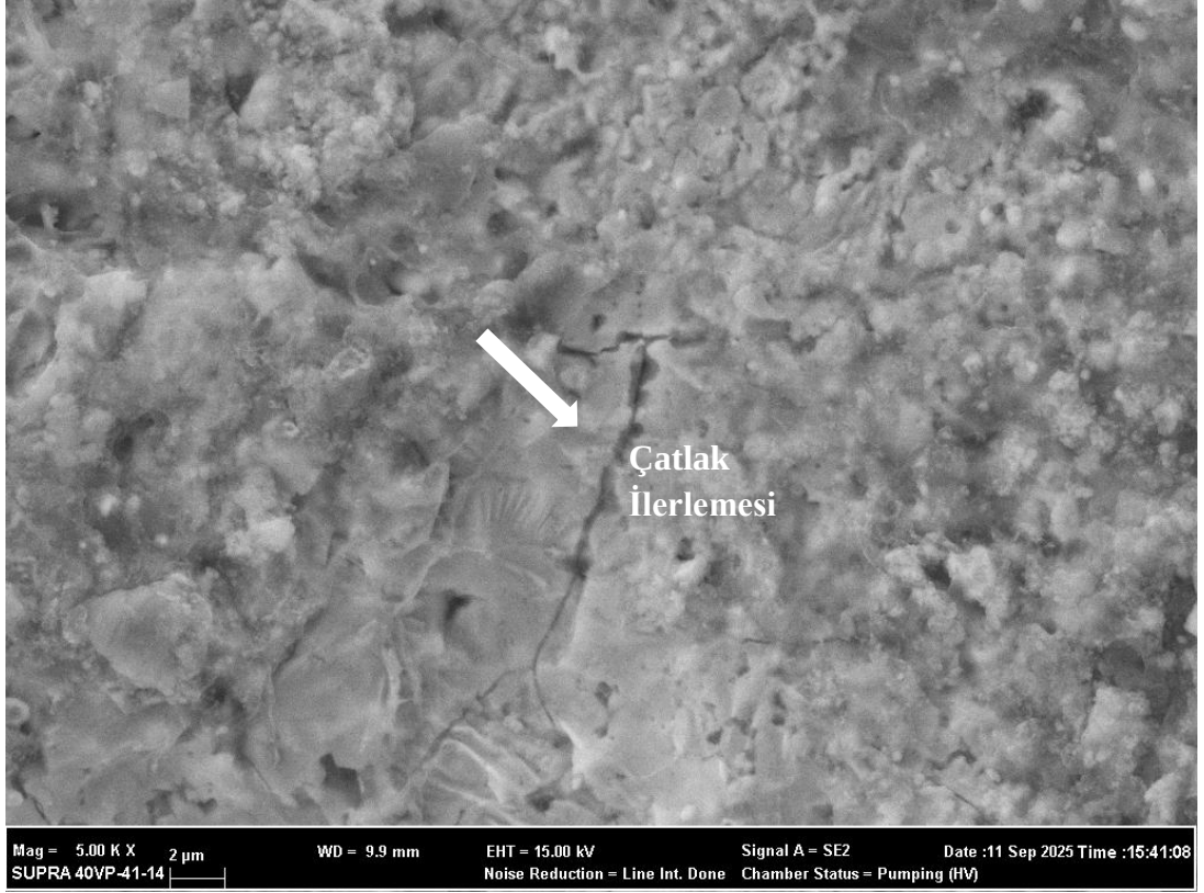
Şekil 6.13. 10 kA-100 ms parametrelerinde NDK işlemi uygulanan SCGA 590 DU çeliğine ait çatlak başlangıcı SEM görüntüsü
