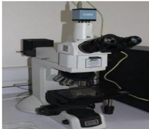
Şekil 5.7. NİKON ECLİPSE LV150N endüstriyel mikroskop
