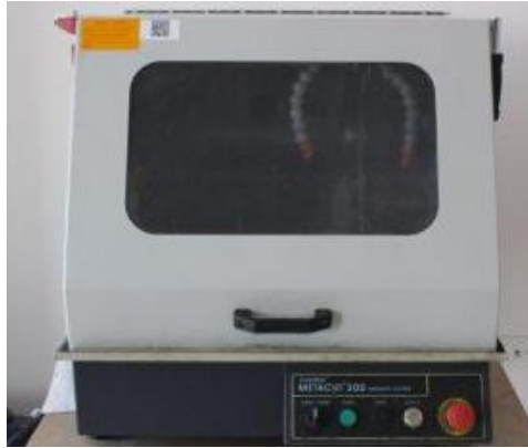
Şekil 5.5. METKON METACUT-300 hassas kesme cihazı
