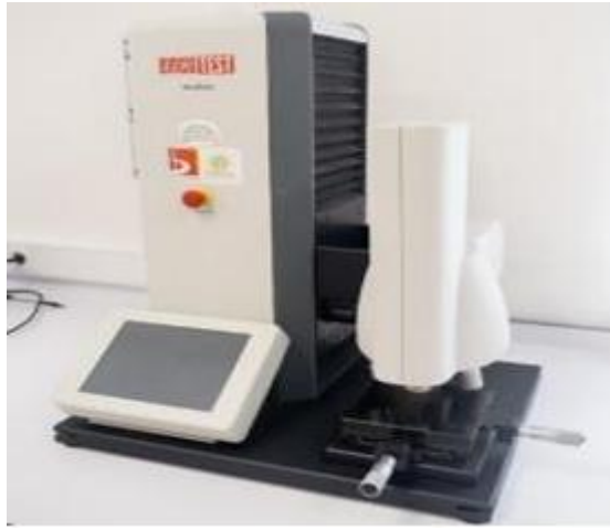
Şekil 5.8. EMCOTEST DUROSCAN 20 mikro sertlik ölçüm cihazı
