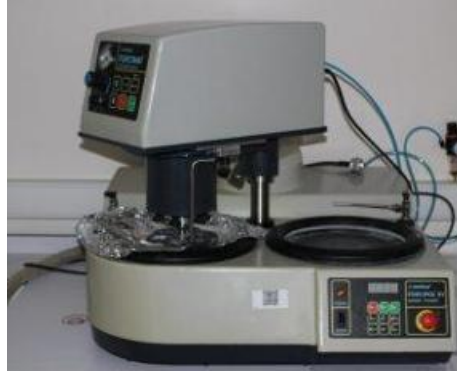
Şekil 5.6. MEKTON FORCİPOL 2V zımparalama ve parlatma cihazı
