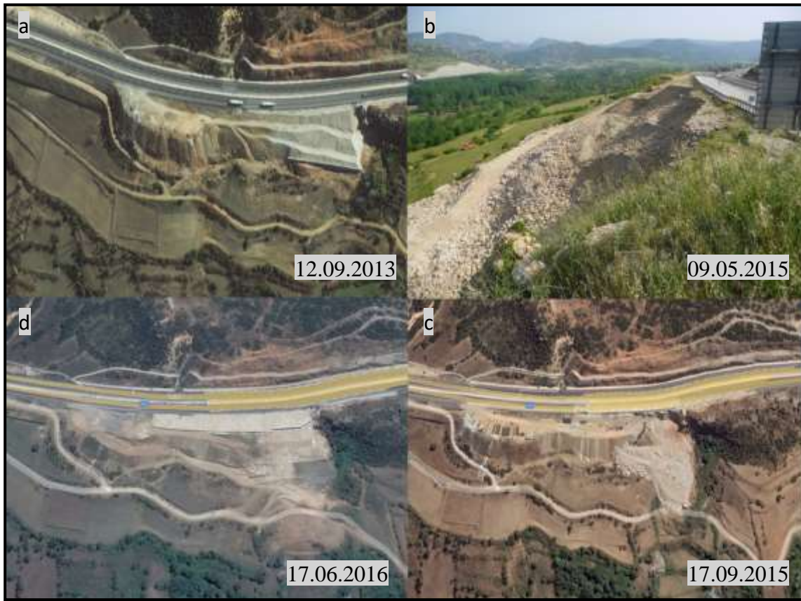
Görsel 13. Bilecik çevre yolunda oluşan kütle hareketinin farklı zamanlara ait Earth Google (a, c ve d) ve araziden çekilmiş (b) görüntüleri.
