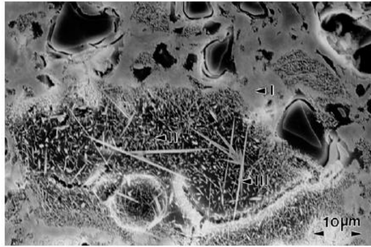
Şekil 2.19. Müllitin 3 tipini içeren porseleninin ikincil elektron SEM görüntüsü
