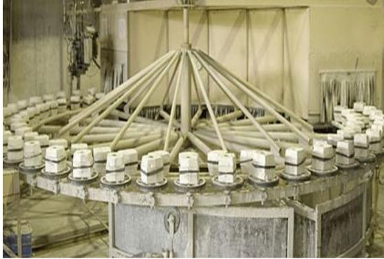
Şekil 2.10. Döküm şekillendirme a) Alçı döküm kalıpları b) Basıncılı döküm makinesi
