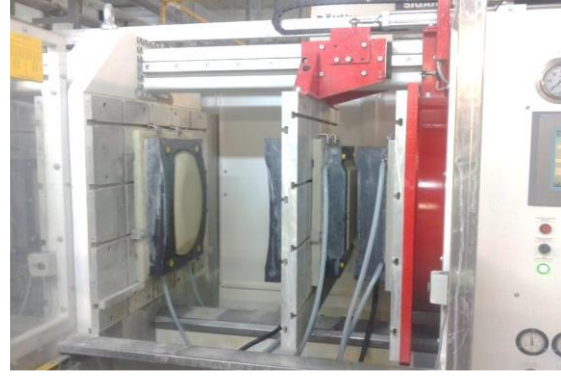
Şekil 2.10. Döküm şekillendirme a) Alçı döküm kalıpları b) Basıncılı döküm makinesi
