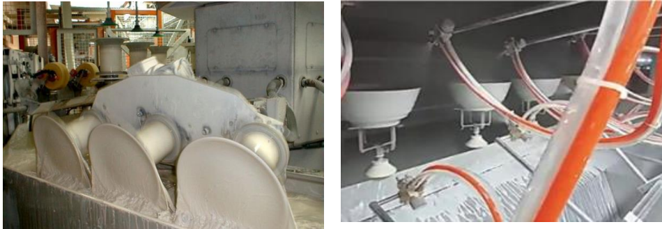
Şekil 2.16. Sırlama (a) daldırma ile sırlama (Lippert 2021) b) püskürtme ile sırlama
