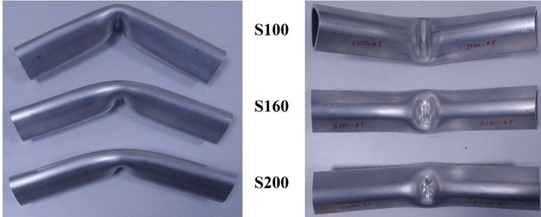
Şekil 4.5. Yamuk kesit geometrisinin R5 zımba yarıçapı için farklı mesnet mesafelerinde deforme olmuş formları
