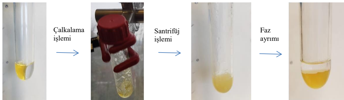
Şekil 8.10. Sıvı - sıvı ekstraksiyon prosesinin aşamaları.
