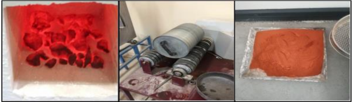
Şekil 2.2. Terra rosa malzemesinin kalsinasyon ve öğütme süreçleri
