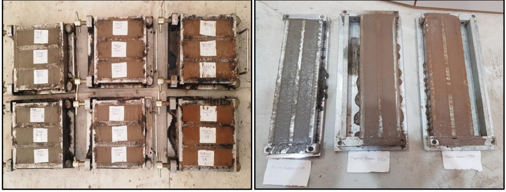
Şekil 2.4. Üretilen 40x40x160 mm ve 25x25x285 mm boyutlu harç numuneleri
