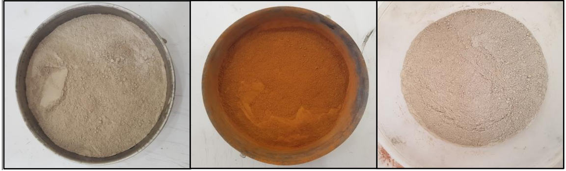
Şekil 2.3. Tüf, terra rosa ve pomzanın öğütülüp elenmiş durumları
