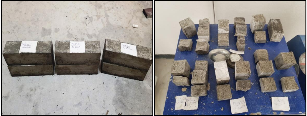
Şekil 3.1. Sertleşmiş harç numuneleri ve basınç dayanımı deneyi sonrası numuneler
