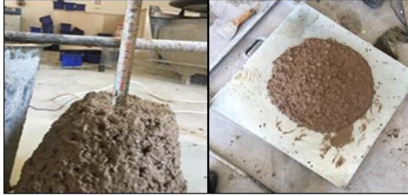
Şekil 3.4. Taze betonda çökme ve yayılma tablası deneyinin yapılışı
