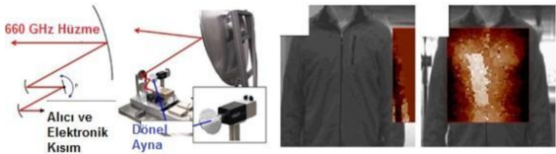
Şekil 2.11 0.6THz FMCW görüntüleme sistemi ve sonuçlar.
