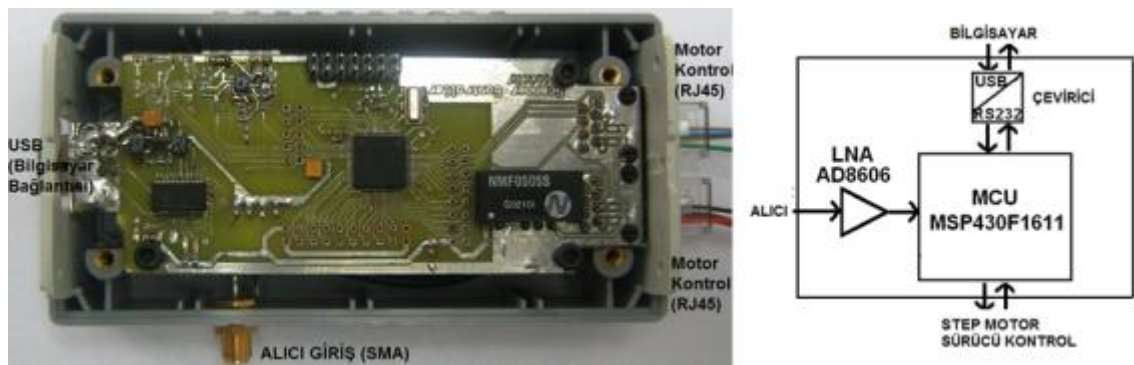
Şekil 3.8 Bilgisayar kontrol ünitesi ve bağlantı noktaları.
