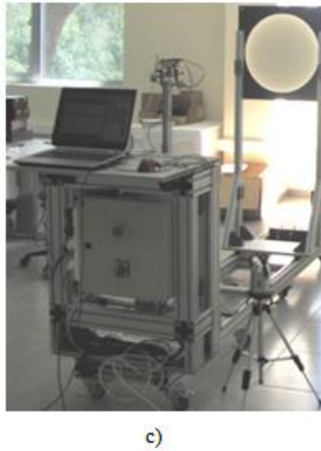
Şekil 3.36 Terahertz görüntüleme sistemi a) Tarayıcı kısmı b) Mercek tarafından görünüm c) Ön taraf
